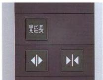
複数の荷物をエレベーターで運ぶときなど、このボタンを押せば一定時間ドアが開いた状態となるので、作業効率が上がります。
