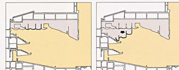
①天井の一部を昇降、または開閉式とし、音の反射率を調整する方式
