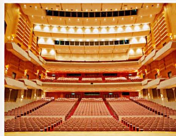
客席3階部分の前面を閉じて、ホール全体の音の反射率を調整したパターンです。
