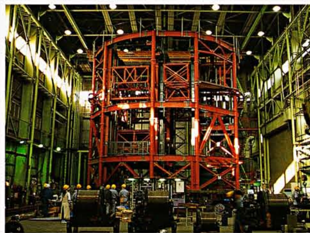
■円筒型回り舞台(大阪松竹座)工場仮組試運転
