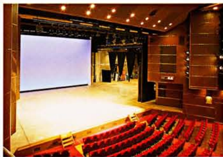
⑤ 主舞台にステージワゴン(回り舞台) セット完了 上手沈下床、舞台レベルに上昇
