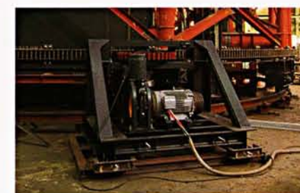
■円筒型回り舞台(大阪松竹座)工場仮組試運転
